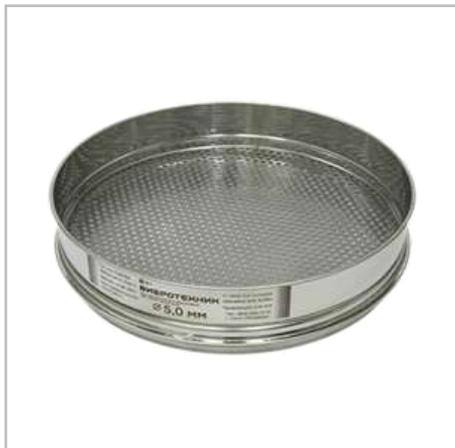
С30-50 – сита лабораторные с внутренним диаметром 300 мм, высотой 50 мм. Тип просеивающего полотна – сетка, перфорированное полотно.
