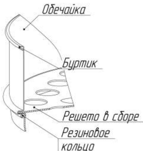
Перфорированное полотно сита изготавливается тремя различными способами:
