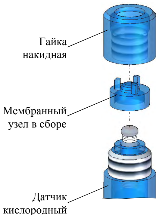
Рисунок 3.4 – Замена мембранного узла
