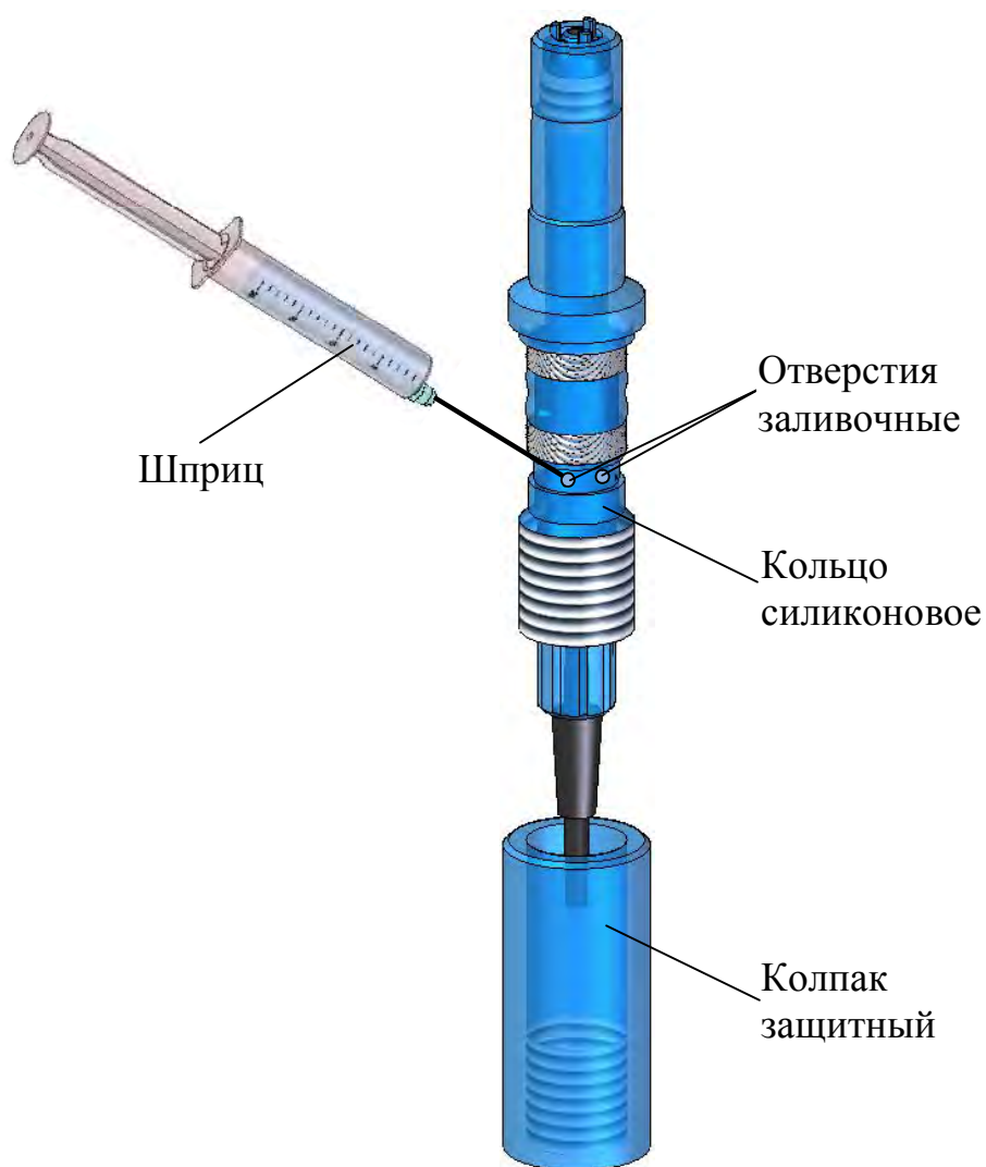
Рисунок 3.1 – Замена электролита ЭК
