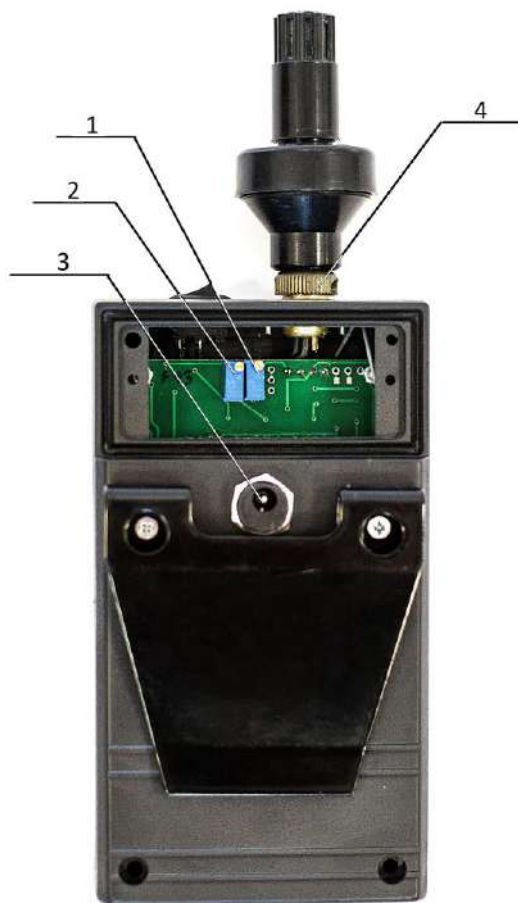
Рис.3. Вид газоанализатора СИГНАЛ-4М сзади со снятой крышкой.
