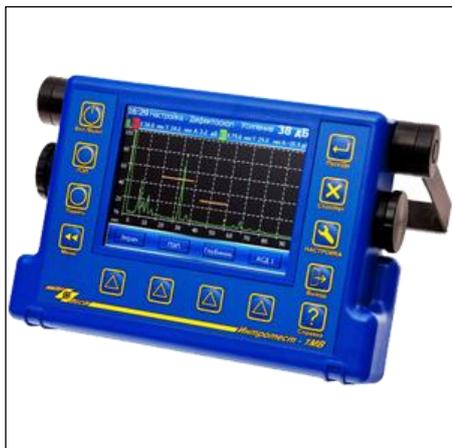
Портативный, ультразвуковой дефектоскоп общего назначения ИНТРОТЕСТ-1М предназначен для обнаружения дефектов типа несплошностей в различных материалах, изделиях и сварных соединениях. Дефектоскоп позволяет измерять координаты дефектов и толщину стенки.
