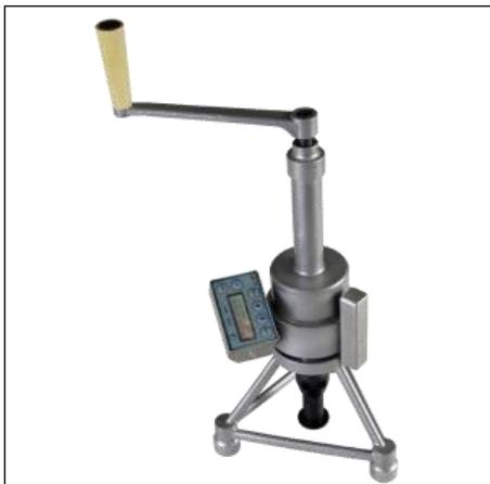
Приборы ПОС-50МГ4 предназначены для неразрушающего контроля прочности бетона методом отрыва со скалыванием и скалывания ребра по ГОСТ 22690.
