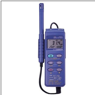
Цифровой измеритель **CENTER-314** предназначен для контроля влажности и температуры товаров и объектов. Измерение температуры воздуха осуществляется в диапазоне от -200 до 1370 °C с соответствующим датчиком (погрешность  $\pm 0,3$  °C, разрешение 0.1 °C), измерение влажности воздуха - в диапазоне от 0 до 100% (погрешность  $\pm 2,5$ %, разрешение 0.1%). Измеритель CENTER оснащен функцией автоматического отключения.
