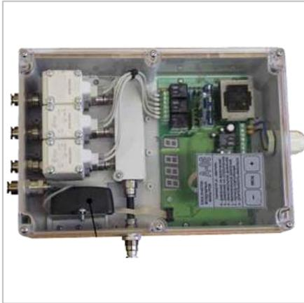
Блок А-06 предназначен для регенерации (очистки от пыли) рукавных и картриджных фильтров.
