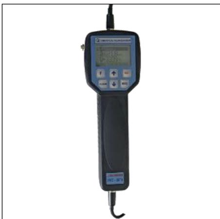
Приборы УКС-МГ4, УКС-МГ4С предназначены для контроля дефектов, определения прочности бетона в сборных и монолитных бетонных и железобетонных изделиях и конструкциях по ГОСТ 17624, определения прочности силикатного кирпича по ГОСТ 24332 и других твердых материалов на основе измерения времени распространения импульсных ультразвуковых колебаний (УЗК) на установленной базе прозвучивания.
