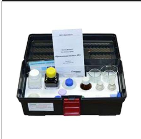
Тест-комплект «Кремниевая кислота-КВ» предназначен для количественного и полуколичественного экспрессного определения концентрации растворенных форм силикатов и кремниевой кислоты (в пересчете на SiO<sub>2</sub>) в исходных водах и производственных водах тепловых электростанций (ОСТ 34-70-953.6-88, МУ 08-47/227, МВИ 13-172-13). Методы определения: визуально-колориметрический, фотоколориметрический.
