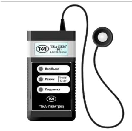
Люксметр ТКА-ПКМ-05 предназначен для измерения освещённости, создаваемой различными источниками.
