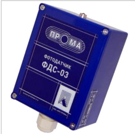
Фотодатчик ФДС-03-220 предназначен для контроля наличия/отсутствия пламени основной горелки и выдачи релейного сигнала в схему защиты котла или установки с целью перекрытия подачи топлива на горелочные устройства в случае отсутствия пламени.
