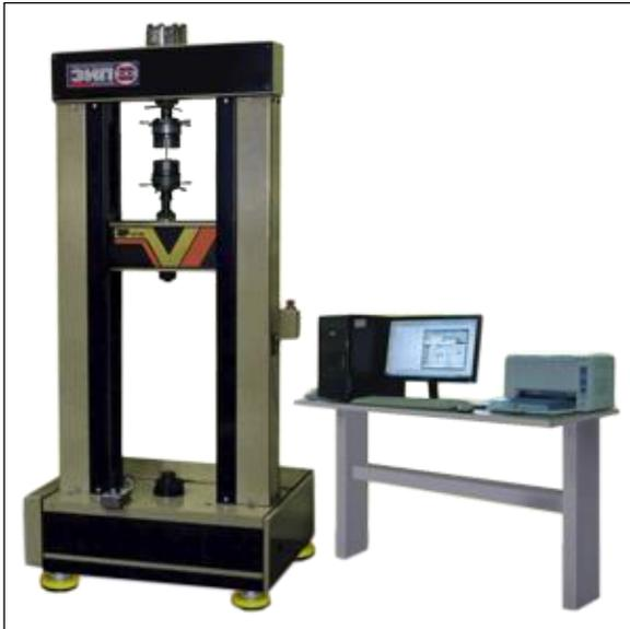
Разрывная машина универсального назначения ИР-5113-100 с электронным силоизмерителем предназначена для испытания образцов материалов и изделий (труб и др.) на растяжение, сжатие и изгиб на 100кН. Устанавливается на виброопорах, специальный фундамент не требуется.
