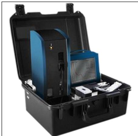
Минилаборатория BALTECH OA-5800 обеспечивает полноценную диагностику смазочных материалов с определением таких показателей, как:
