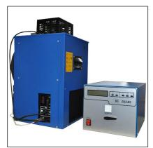
Аппарат **ЛАЗ-МЗ** предназначен для контроля качества нефтепродуктов и позволяет автоматизировать определение температур застывания и текучести топлив и масел, регламентированное ГОСТ 20287, ISO 3016 и ASTM D97.
