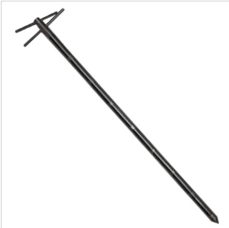
Пробоотборник применяется для отбора проб сыпучих нефтепродуктов и имеет восемь отсеков (на заказ количество отсеков может меняться в любую сторону) для взятия пробы.
