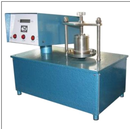
Машина предназначена для определения предела прочности при сжатии формовочных и стержневых смесей в сыром состоянии.
