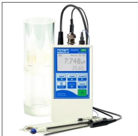
Портативный рН-метр МАРК-903 предназначен для измерения активности ионов водорода (рН), ЭДС и температуры водных сред.
