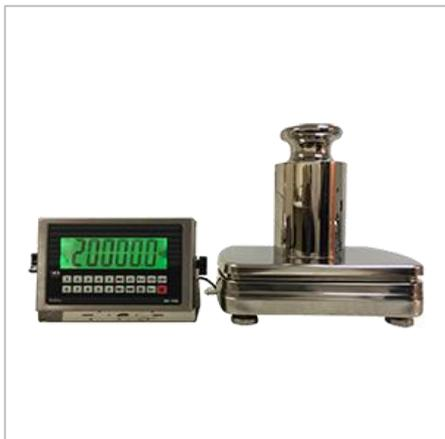
Компаратор ВК-20/0,1М-2 обеспечивает сличение гирь или специальных мер массы класса точности М1.
