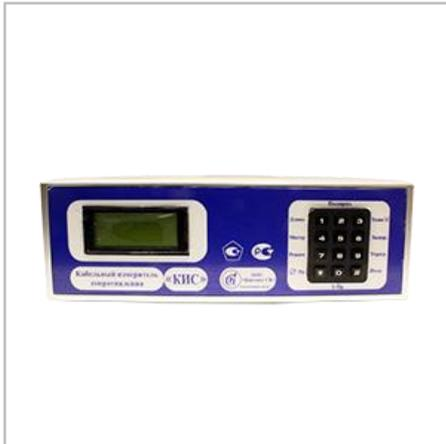
Приборы для измерения сопротивления токопроводящей жилы КИС (миллиомметры) выпускаются в двух основных исполнениях:
