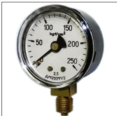
Манометры, вакуумметры и мановакуумметры показывающие ДМ2029, ДВ2029 и ДА2029 предназначены для измерения избыточного и вакуумметрического давления неагрессивных, некристаллизующихся по отношению к медным сплавам жидкостей, пара, газа, в том числе кислорода, ацетилена, пропан-бутана, метана.
