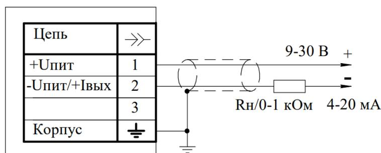
**Схема внешних электрических соединений преобразователей РТМ-2, РТМ-М-2:**
