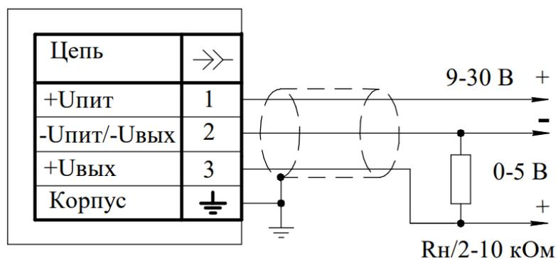
**Схема внешних электрических соединений преобразователей РТМ-М-3:**
