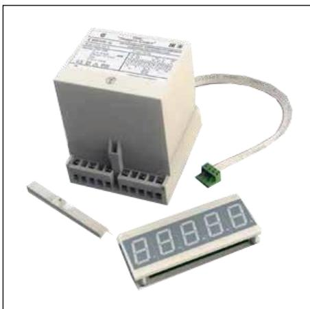
Предназначены для линейного преобразования входного сигнала постоянного тока в цифровой код, передачи результатов преобразования с использованием порта RS-485, отображения результатов измерения на выносном пятиразрядном показывающем устройстве (далее — ПУ), а также для преобразования входного сигнала в унифицированный выходной сигнал постоянного тока или напряжения постоянного тока.
