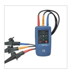
Индикатор DT-902 предназначен для определения направления вращающегося поля, определения порядка подключения обмоток электродвигателя и обнаружения магнитного поля. Представляет собой портативный прибор, работающий от батареек.
