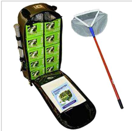
Ранцевая полевая лаборатория исследования водоемов НКВ-Р (базовая модификация) предназначена для определения гидрохимических и почвенно-химических, гидробиологических, визуальных и других показателей непосредственно в полевых условиях. Гидрохимические модули обеспечивают анализ питьевой и природной воды (воды водоемов хозяйственно-бытового, культурно-бытового назначения, поверхностных водоисточников и т.п., а также почвенных вытяжек по 23 показателям.
