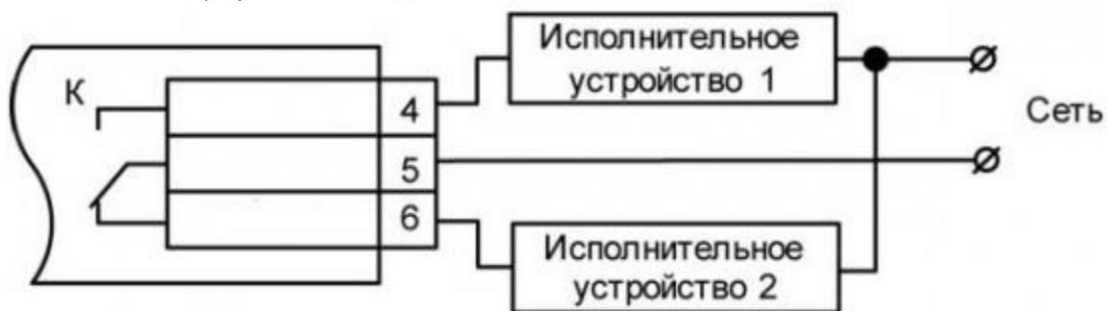
Схема подключения нагрузки к ВУ типа Р
