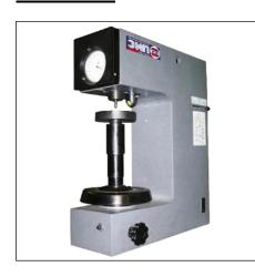
Приборы предназначены для измерения твердости по методу Роквелла металлов и сплавов по ГОСТ 9013, пластмасс, графита и электрографита. Приборы позволяют измерять твердость в соответствии с ISO 6508, DIN 50103 и ASTM E 18.
