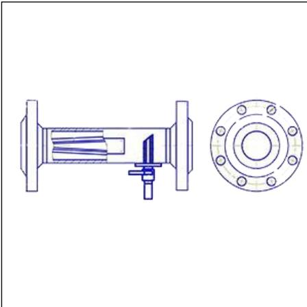
Пробоотборник для ручного отбора проб «1СТАНДАРТ-Р» предназначен для отбора проб товарной нефти и нефтепродуктов.
