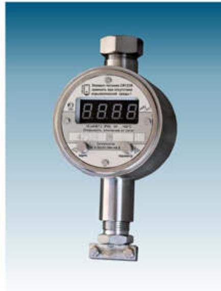
Рис. 11. Сигнализатор MC-K-500-БП-ЛИН-НЖ-ВЗ имеет встроенный элемент питания, предназначен для применения в автономных системах измерения. По сравнению с сигнализатором MC-K-500-БП-ЛИН-ВЗ (рис. 10) корпус выполнен из стали 12Х18Н10Т, полость корпуса заполнена компаундом.
