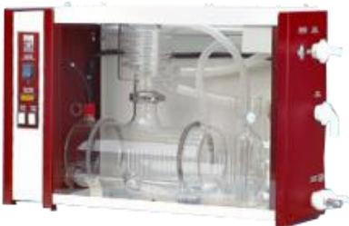
Полностью автоматический стеклянный дистиллятор для одинарной перегонки воды, подходит как для настольного, так и настенного размещения. Дистилляторы GFL используются в исследовательских лабораториях, например при подготовке медицинских и бактериологических образцов, культур клеток и тканей, а также при приготовлении реагентов. Кроме этого, получаемый дистиллят используется для процессов очистки и стерилизации, при приготовлении буферных растворов, а также в аналитических целях.
