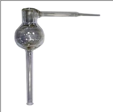
Криогенная ловушка предназначена для предварительной очистки вакуума с помощью вымораживания паров воды и газов, а также для предотвращения проникновения паров масла из масляного вакуумного насоса в рабочий объем. Ловушка выполнена из стекла С52-1.
