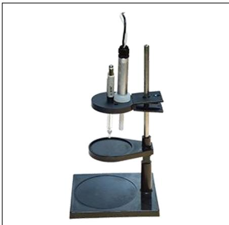
Вольтамперический анализатор «Экотест-ВА» комплектуется двумя типами электрохимических датчиков с вращающимися дисковыми электродами: Вращающийся дисковый электрод «ВДЭ» и Вращающийся дисковый электрод с уплотнением «ВДЭ-У».
