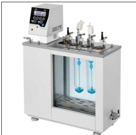
Жидкостные переливные термостаты с прозрачными стенками ВИС-Т-08-4 и ВИС-Т-09-4 предназначены для поддержания заданной температуры при проведении измерений вязкости нефтепродуктов с помощью стеклянных вискозиметров в соответствии с ГОСТ 33, ГОСТ Р 53708, ASTM D445, IP 71, ISO 3104 и DIN 51366.
