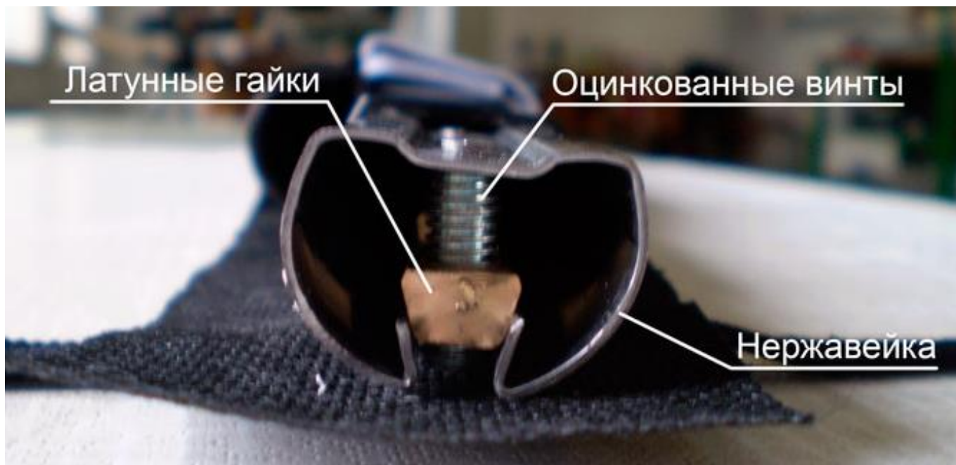
Соединение метроштока с Т-образным профилем
