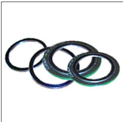
Спирально-навитые прокладки «СНП» применяются для уплотнения «гладких» фланцевых соединений, соединений типа «выступ-впадина», «шип-паз» арматуры, трубопроводов, сосудов, аппаратов, насосов и аналогичного оборудования химической, нефтеперерабатывающей и других отраслей промышленности при температуре рабочей среды от -196 до 600 °С и давления до 25 МПа.
