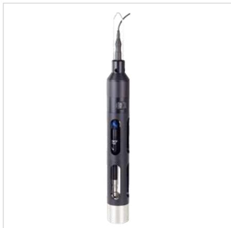
Многопараметрический датчик MPP-930-IDS предназначен для одновременного измерения до трех параметров: растворенный кислород (оптический), pH или ОВП, проводимость, а также мутность. Встроенный датчик давления определяет глубину. Каждый датчик измеряет температуру, необходимую для ее компенсации самостоятельно. MPP-930-IDS может измерять до 3 параметров.
