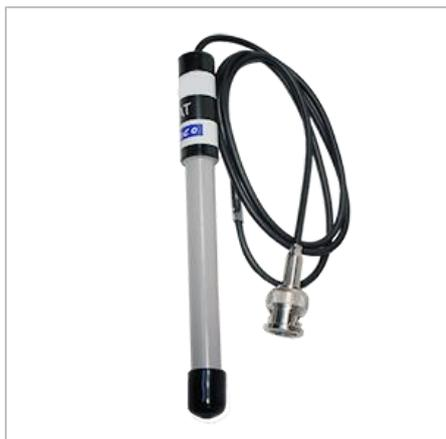
Электрод хлорид-селективный Элит-261 с кристаллической мембраной предназначен для измерения активности (концентрации) ионов хлорида. Используется для анализа сточных вод, вод с органическими растворителями, нефтепродуктами.
