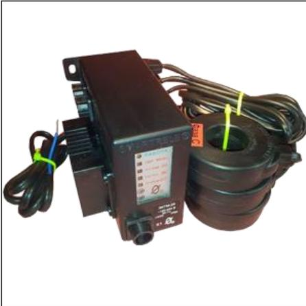
Контроллер ЭКТ(М) обеспечивает защитное отключение электродвигателя при возникновении недопустимых (аварийных) режимов работы. Контроллеры предназначены для установки в цепях питания трехфазных электродвигателей переменного тока промышленной частоты 50 Гц напряжением 220/380 В. При косвенном подключении через трансформаторы тока контроллеры ЭКТ(М)-1.5, ЭКТ(М)-2.5 могут использоваться в электролиниях на любое напряжение.
