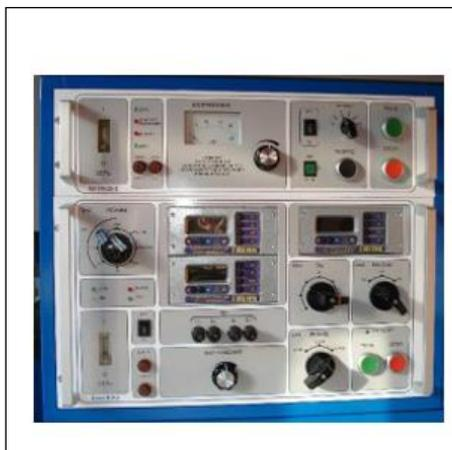
Блок **К-0,4** предназначен для осуществления контроля состояния силовых и измерительных трансформаторов. В состав блока входит блок **К - 0,4** и трансформатор разделительный **ТР -2**. Блок позволяет осуществить следующие виды контроля состояния трансформаторов:
