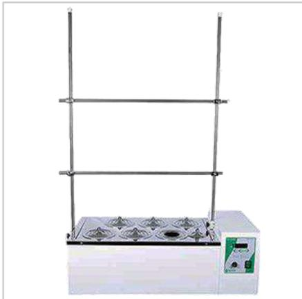
Шестиместная лабораторная Баня ЭКРОС-4300 (ПЭ-4300) предназначена для проведения химических, биологических, фармацевтических процессов, требующих нагрева при постоянной температуре в диапазоне температуры окружающей среды +5...+100°С в лабораторных условиях.
