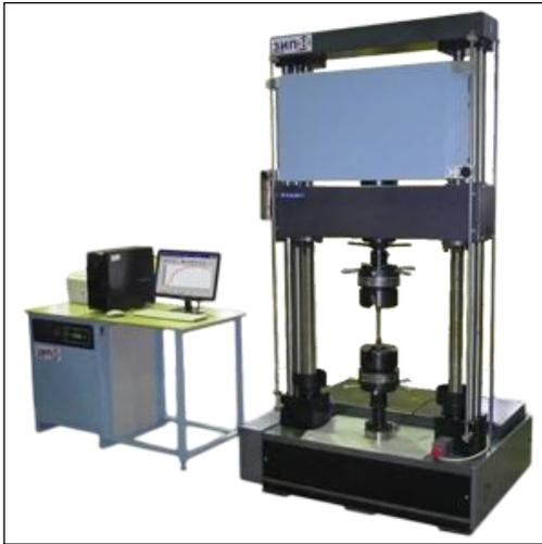
Разрывная машина универсального назначения ИР-5143-200 с электронным силоизмерителем предназначена для испытания образцов материалов и изделий (труб и др.) на растяжение, сжатие и изгиб на 200кН. Устанавливается на виброопорах, специальный фундамент не требуется.
