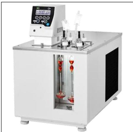
Жидкостные криостаты КРИО-ВИС-Т-06 и КРИО-ВИС-Т-06-01 со стеклопакетом, исключающим запотевание и обмерзание, предназначены для поддержания заданной температуры при проведении измерений вязкости нефтепродуктов при помощи стеклянных вискозиметров в соответствии с ГОСТ 33, ГОСТ Р 53708, ASTM D445 и определении температуры застывания нефтепродуктов в соответствии с ГОСТ 20287.
