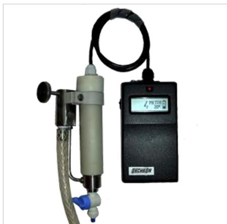
Анализаторы растворенного кислорода Оксикон-02П и Оксикон-02С предназначены для измерения массовой концентрации растворенного в воде кислорода при контроле качества воды.
