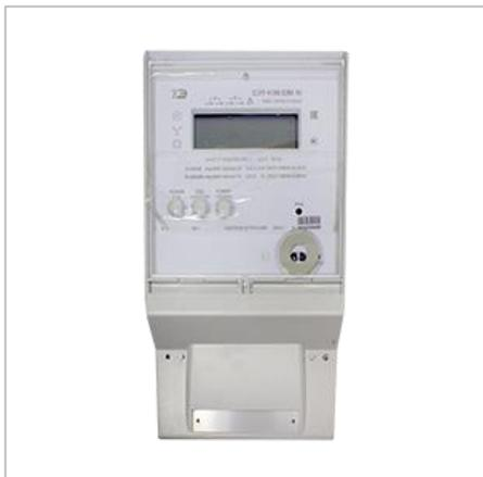
Счетчики СЭТ-4ТМ предназначены для измерения и многотарифного учета активной и реактивной электроэнергии (в том числе и с учетом потерь), ведения массивов профиля мощности нагрузки с программируемым временем интегрирования (в том числе и с учетом потерь), фиксации максимумов мощности, измерения параметров трехфазной сети и параметров качества электроэнергии.
