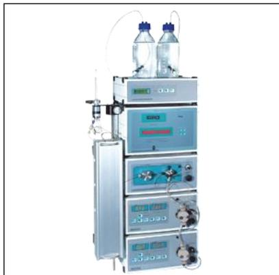
Хроматографическая система с переменным составом элюента (с градиентным элюированием) предназначена для исследований сложных смесей органических соединений в том случае, когда невозможно подобрать условия удовлетворительного разделения всех компонентов в изократическом режиме. Прибор с успехом может применяться как для рутинных анализов, так и для выполнения сложных научных исследований.
