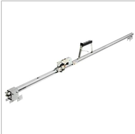
Путевой шаблон ПШ-1520В представляет собой переносной инструмент для измерения параметров железнодорожного пути: ширины колеи, относительного возвышения рельсов (уровня), ширины желоба, ординат переводных кривых, размеров сердечник крестовины-контррельс и контррельс-усовик, определения бокового износа путевого рельса (размер справочный).
