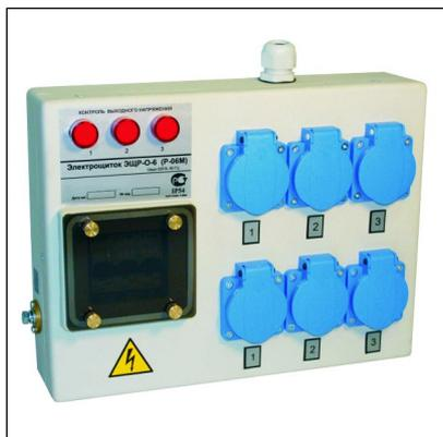
Электрощит розеточный **ЭЩР-О-6** предназначен для подключения конечных потребителей электрической энергии второй группы по ГОСТ 50571.28-2006 к электросети напряжением 220В 50 Гц посредством евро-розеток с контактом заземления, расположенных на лицевой панели. ЭЩР-О-6 может использоваться для подключения медицинского оборудования в операционных, предоперационных, травматологических, анестезиологических кабинетах, реанимационных палатах и палатах интенсивной терапии.
