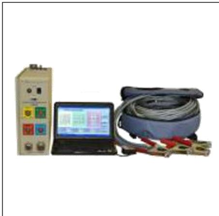
Измеритель параметров трансформаторов СА540 предназначен для измерения характеристик силовых трансформаторов (трехфазных и однофазных) при проведении низковольтных испытаний.
