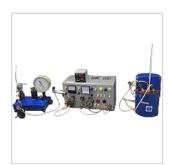
Поверочная установка А2246 предназначена для (калибровки) электроманометров и электротермометров в условиях локомотивного депо.
