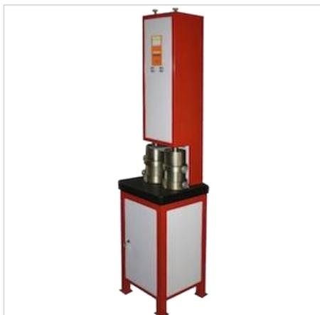
Прибор ПСУ-МГ4 предназначен для лабораторного определения максимальной плотности грунта по методу ГОСТ 22733.
