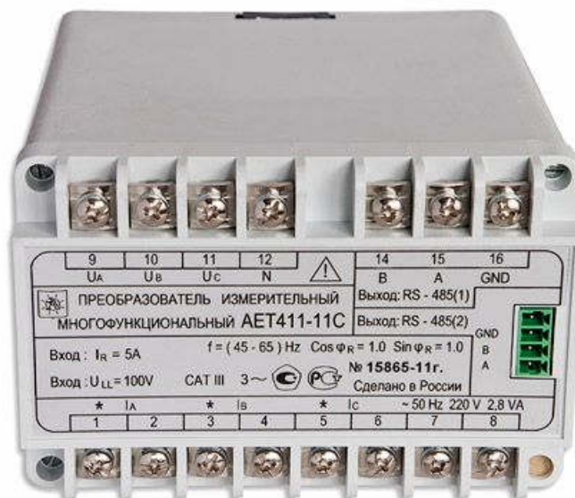
Бюджетная версия многофункционального измерительного преобразователя АЕТ411-11С
